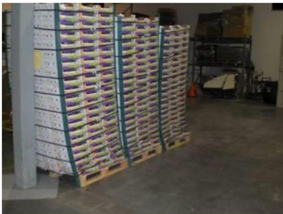
ภาพที่ 8 บรรจุภัณฑ์ถาดกระดาษลูกฟูกที่ไม่เหมาะสมกับขนาดของแท่นรองรับสินค้า
